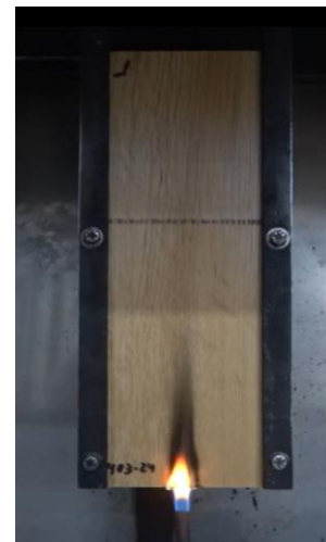
Fotografia 4 – A chama não atinge a marca de 150 mm.
