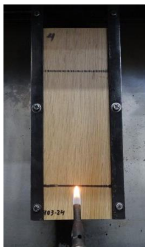
Fotografia 5 – Ensaio com o queimador aplicado na superfície do corpo de prova.
